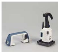
リモートキャッチャーシステムを追加すれば、半径 300m の範囲でワンマン測量が可能。万が一追尾をロストしても、スムーズに観測を続けることができます。
